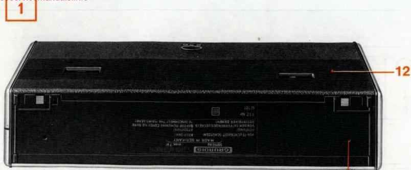
R 5 zum Einstellen der Bandgeschwindigkeit. Dazu Testbandcassette 466 abspielen. 3150 Hz Aufzeichnung bei Messung mit Tonschwankungsmesser (z. B. Fa. Woelke ME 101). 50 Hz Aufzeichnung bei Vergleich mit der Netzfrequenz mittels Oszillograf (Lissajous'sche Figur).
